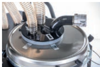
Bedieneinheit der Schubumkehr zur Behälterentleerung (Flüssigkeiten).
