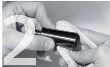
Für maximale Spannkraft ist bei jedem Werkzeugwechsel die Bohrung, der Werkzeugschaft, der Konus der Spannhülse und der Innenkonus vom Spannfutter zu entfetten.
