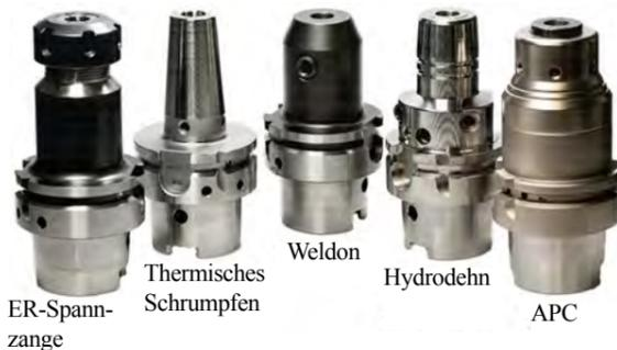
Abb. 1 Beispiele der untersuchten Werkzeughaltersysteme
