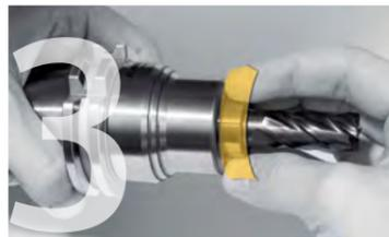
Gereinigter u. unbeschädigter Werkzeugschaft in die Spannhülse einschieben, dabei ist die Mindesteinspanntiefe, siehe Seite 83, zu beachten. Von Hand Spannhülse mit Werkzeug in das Futter einschrauben bis die Spannhülse am Konus anliegt.
