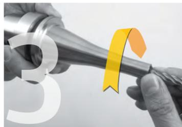
Gereinigter und unbeschädigter Werkzeugschaft in die Spannhülse einschieben, dabei ist die Mindesteinspanntiefe, siehe Seite 89, zu beachten. Von Hand Spannhülse mit Werkzeug in das Futter einschrauben bis die Spannhülse am Konus anliegt.
