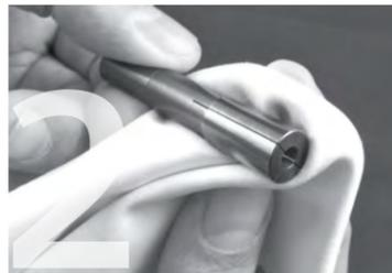
Für maximale Spannkraft ist bei jedem Werkzeugwechsel die Bohrung, der Werkzeugschaft, der Konus der Spannhülse und der Innenkonus vom Spannfutter zu entfetten.
