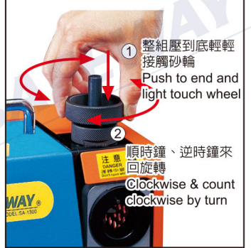
D. 逃隙角研磨 / Chisel Edge Angle
