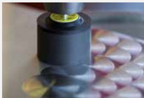
Primer dekorativnega brušenja z uporabo R-Flex SFM 656 marmornega elementa iz nerjavečega jekla
