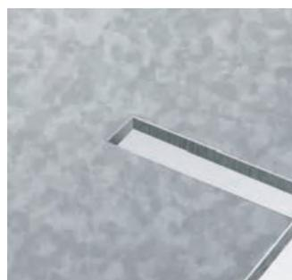
Ausklinken und Spanbrechen in einem Arbeitsgang
