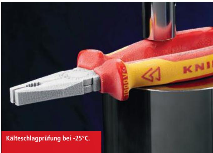
Kälteschlagprüfung bei -25°C.
