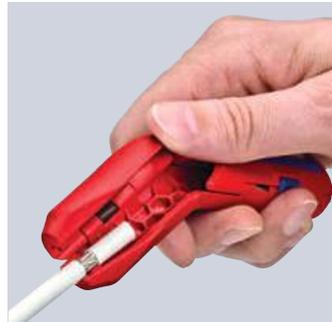
Abmanteln eines Koaxialkabels
