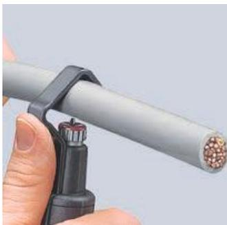
Ansetzen des Werkzeugs für Umfangsschnitt
