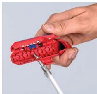
Abisolieren eines Koaxialkabels
