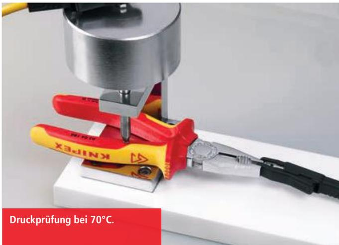
Druckprüfung bei 70°C.
