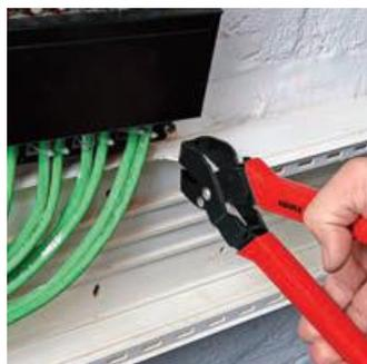
Mit der KNIPEX Ausklinkzange lassen sich einfach, schnell und sauber die gebräuchlichsten Aussparungen in Kunststoffleisten und Kabelkanälen realisieren. Kein umständliches Aussägen oder Ausknabbern und aufwendiges Nacharbeiten
