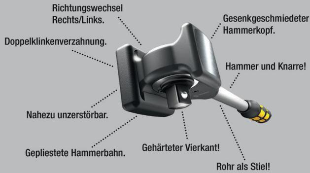
Die Knarre, die man auch sachgemäß als Hammer einsetzen kann. Der Koloss ist als Umschalt- und Schwerlastknarre mit mindestens 600 Newtonmeter Belastbarkeit einsetzbar. Die Doppelklinkenverzahnung und der minimale 6°-Rückholwinkel sorgen für schnelles und präzises Schrauben auch in engen Schraubsituationen.
