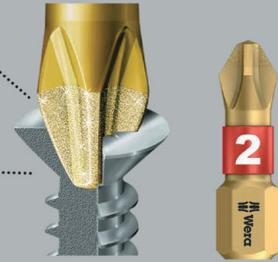
Die Diamantbeschichtung der Bits sorgt für sicheren Sitz in der Schraube, reduziert den benötigten Anpressdruck und reduziert die Gefahr des Abrutschens.
