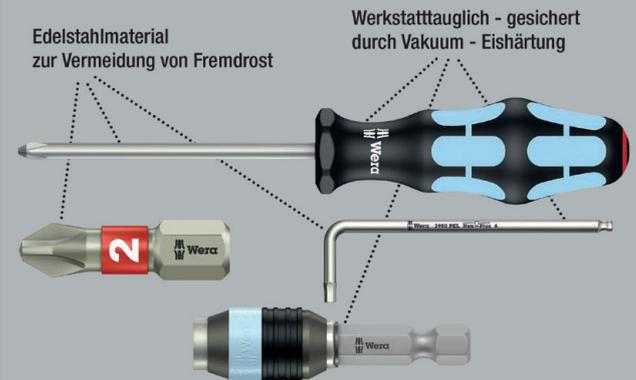
Wera Edelstahl Werkzeuge werden aus Edelstahl gefertigt, wodurch der unansehnliche Fremdrost vermieden wird. Mit Torsionszone: Bei Torsion-Bits werden Drehmomentspitzen in der Torsionszone abgefedert. Vorzeitiger Verschleiß wird vermieden, die Lebensdauer des Bits erhöht. 1/4"-Sechskant, passend für Halter nach DIN ISO 1173-D 6,3.
