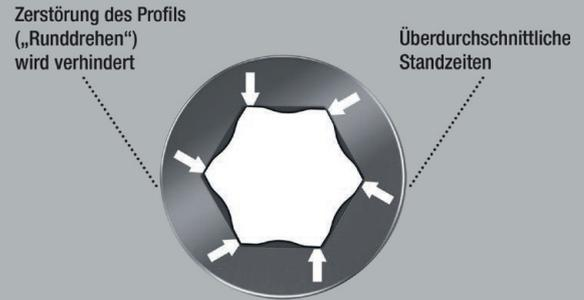
Hex-Plus bietet größere Anlageflächen im Schraubekopf. Die Kerbwirkung wird dadurch auf ein Minimum reduziert, die Zerstörung des Schraubekopfes nahezu eliminiert.
